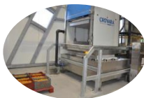
Douchage caisses machine Crovara et trempage caisses dans bac expérimental
